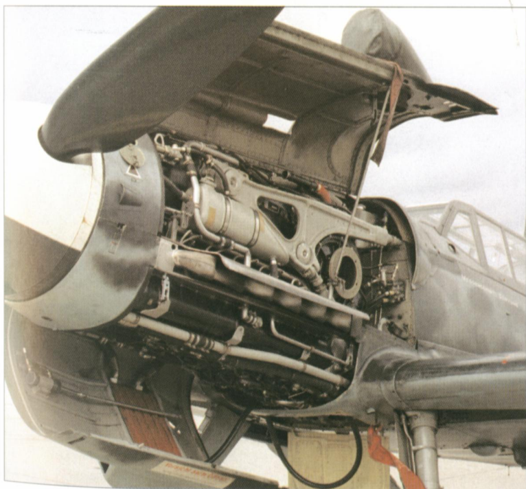
Page 22 and 23. Details of Daimler-Benz DB 605 A-1 engine. [Paweł Przymusiła]
