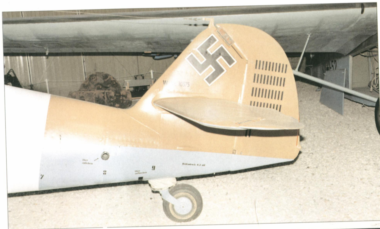
Details of tail and tail wheel of Bf 109G-2/R3 Trop. [Paweł Przymusiła]
